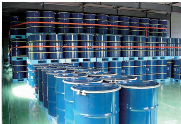
航空自衛隊恩納分屯基地内の保管庫に収納されているPCB含有汚泥のドラム缶
