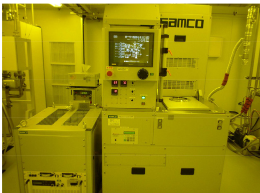
図7 (左) 使用した NPJ 設備の一例 (右) 実施機関が保有する NPJ 設備の一例 深掘りエッチング装置 (サムコ製) 高精細集束イオンビーム装置 (Zeiss 製)
