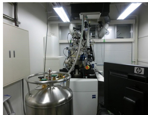
図7 (左) 使用した NPJ 設備の一例 (右) 実施機関が保有する NPJ 設備の一例 深掘りエッチング装置 (サムコ製) 高精細集束イオンビーム装置 (Zeiss 製)
