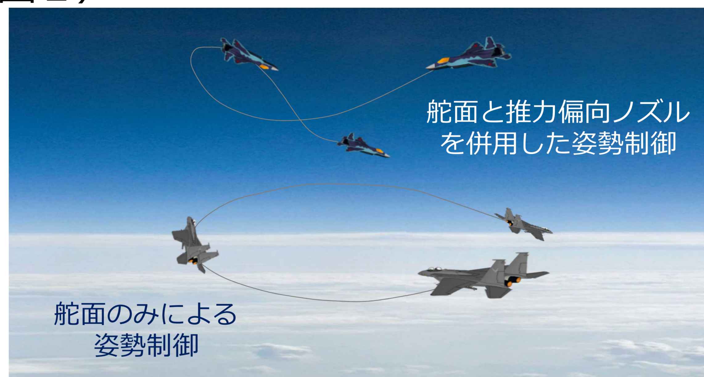
図2 推力偏向ノズルの効果(イメージ)
