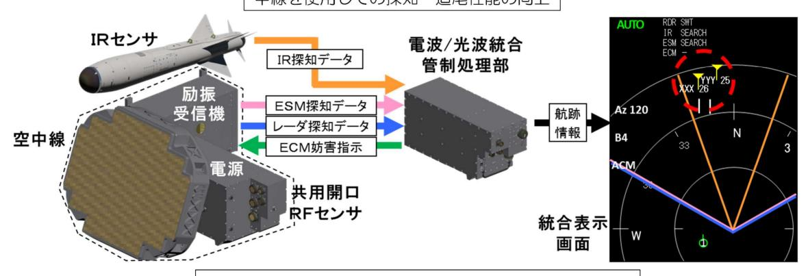
共用開口RFセンサのレーダ及びESMの協調動作並びに IRセンサとのセンサ統合による探知・追尾性能の向上
