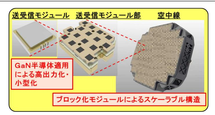
GaN素子を用いて高出力化を図った空中線を使用しての探知・追尾性能の向上
