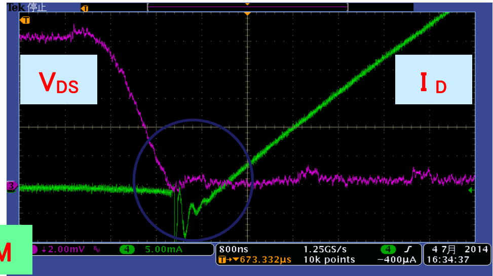
図8.30 ZVS動作の実測波形 ( V_{DS} - I_D )
