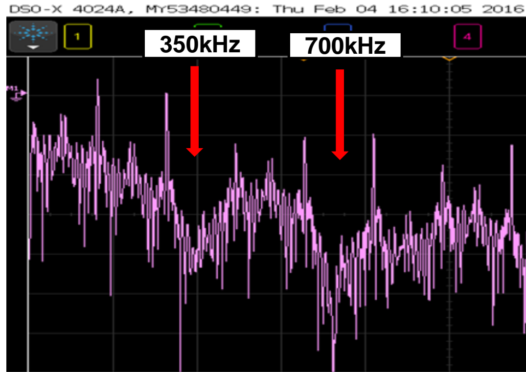
図10.14 PWC方式スペクトラム(2)
