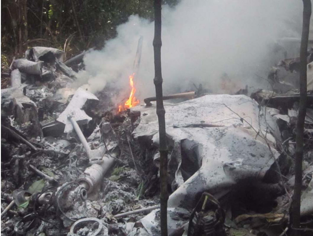
Incendio de la cabina en la parte lateral delantera del lado derecho.
