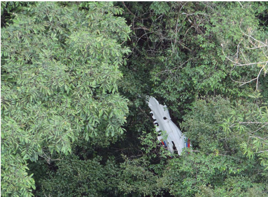
Restos del botalón de cola del OB-1916-P, encontrado en la cresta de los árboles, a una altura aproximada de 35 metros sobre el terreno
