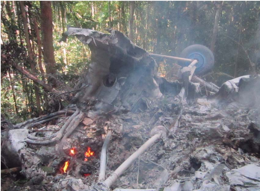
Incendio de la cabina que impacto en posición invertida, con los motores en contacto a tierra y los trenes de aterrizaje hacia arriba.
