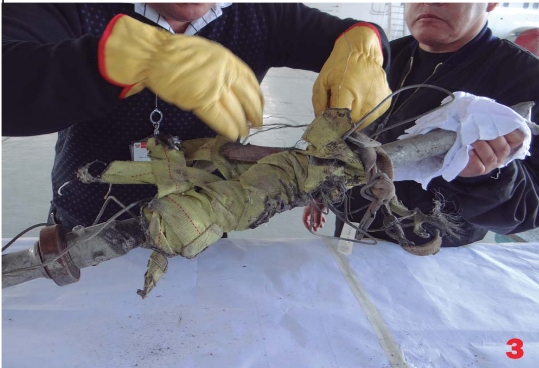
Desenrollado de la malla de estiba y los cables de los controles de pedales del rotor de cola.
