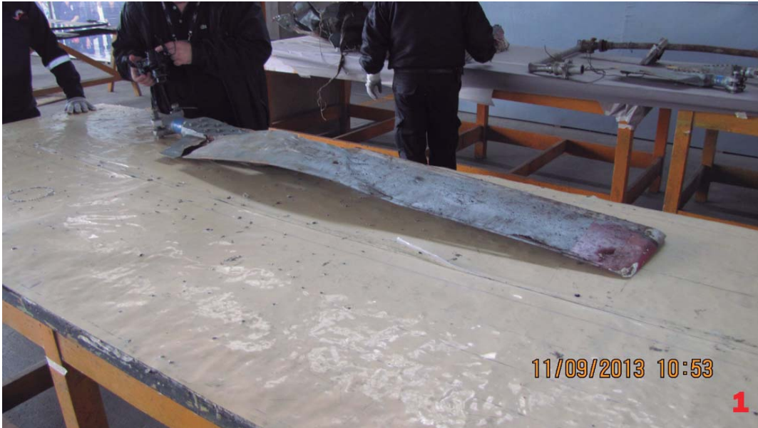
Primera pala inspeccionada que se encontró rota en la raíz de pala.
