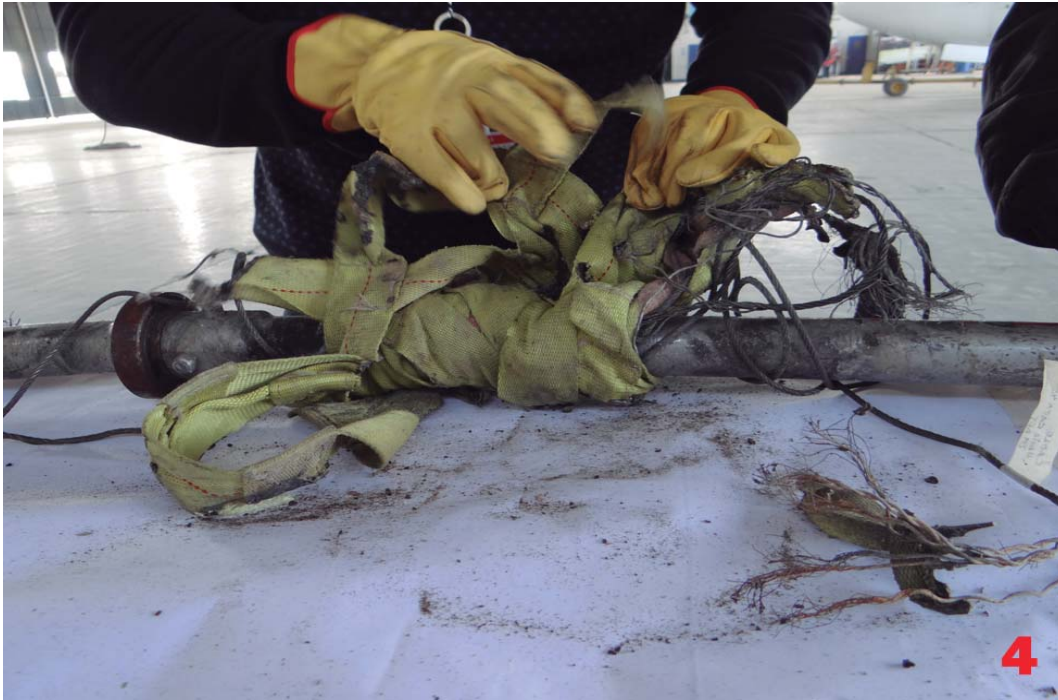
Continuación del desenrollado, donde se encontraba mayor longitud de cable del sistema de control de paso del rotor de cola.
