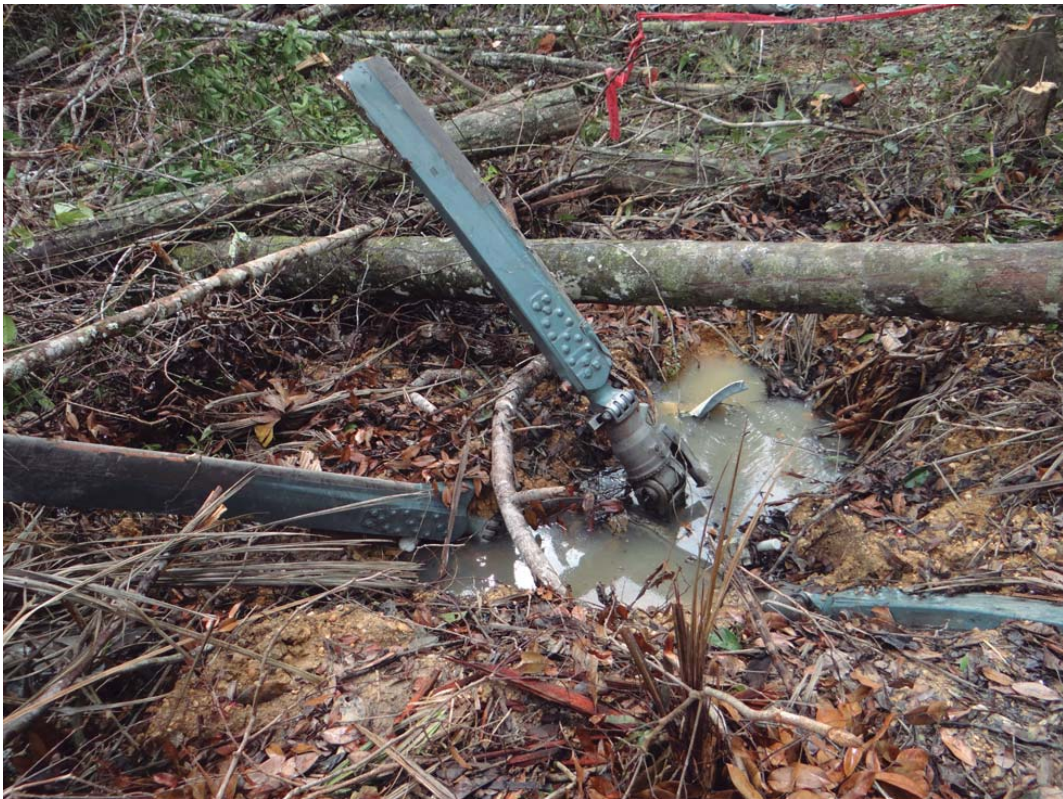
Rotor Principal incrustado a tierra, y con rotura de las palas cercanos a los empotramientos del cubo rotor principal.
