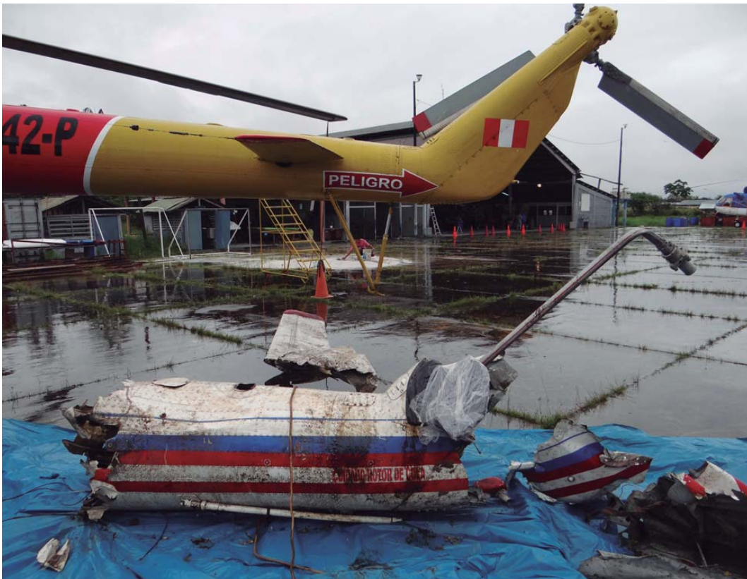
Resto del botalón de cola con el plano horizontal de sustentación.
