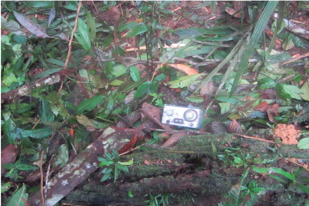
El contenedor de la cinta de grabación del CVR, roto y la cinta de grabación no fue ubicada.
