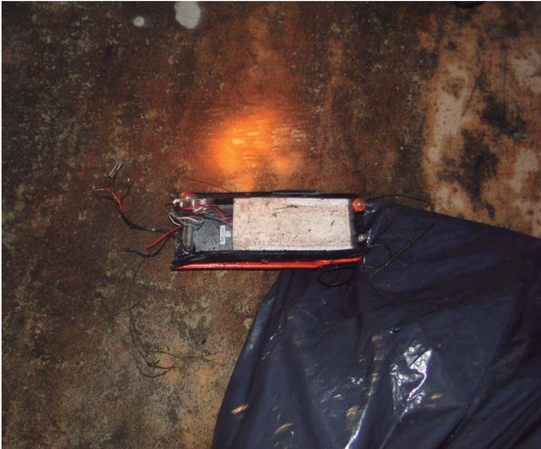
Parte posterior del ELT que muestra que fue separada en dos partes.
