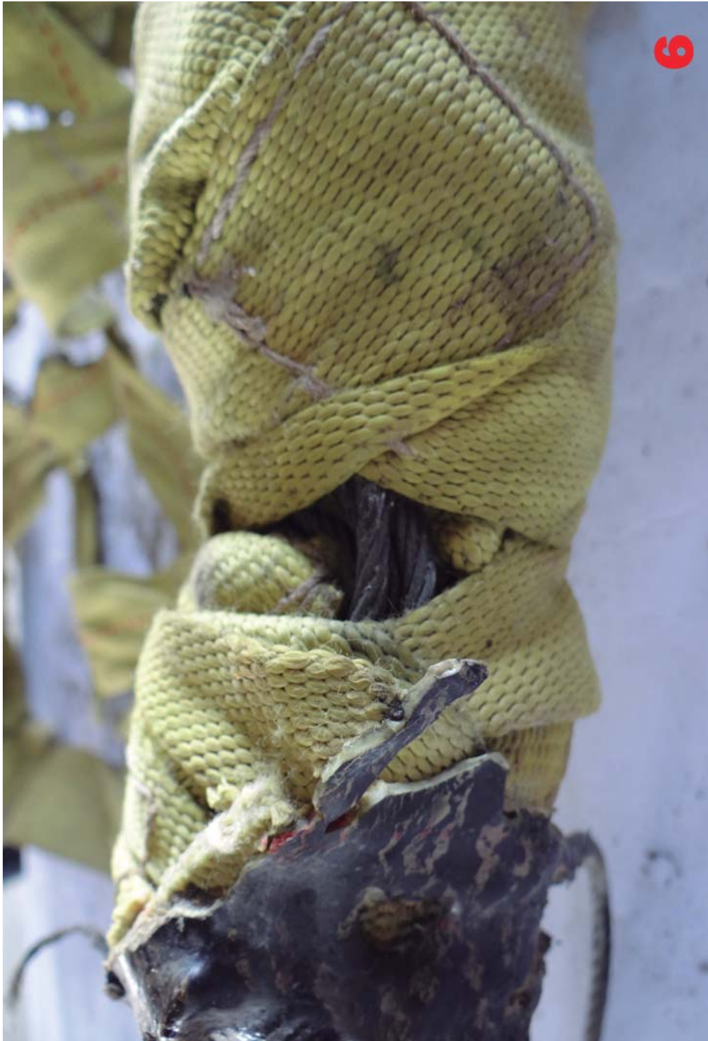
Se observan cables cubiertos por la malla de estiba de carga.
