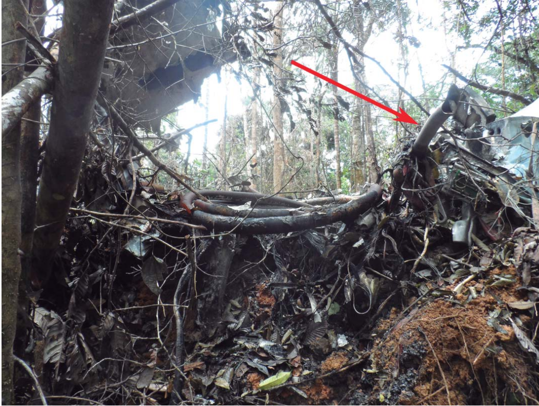
Eje de transmisión de potencia del rotor de cola, fraccionado y aun conectado a los restos.
