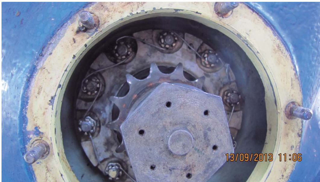
Deformación en la cara de los dientes, por tensión de la cadena de transmisión de movimiento.
