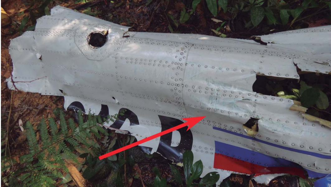
Restos del botalón de cola desprendido del OB-1916-P, recuperado de los árboles, con restos de pintura de Pala de Rotor Principal.
