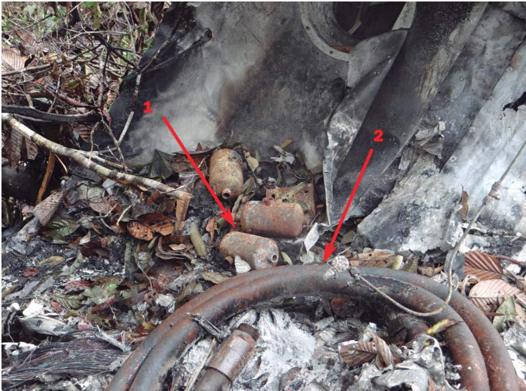
N° 1, muestra los purificadores de combustible, N° 2 manguera de alta presión.
