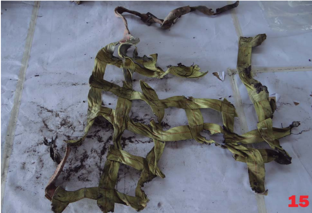
Malla que fue desenroscada del eje de transmisión de potencia hacia el rotor de cola.
