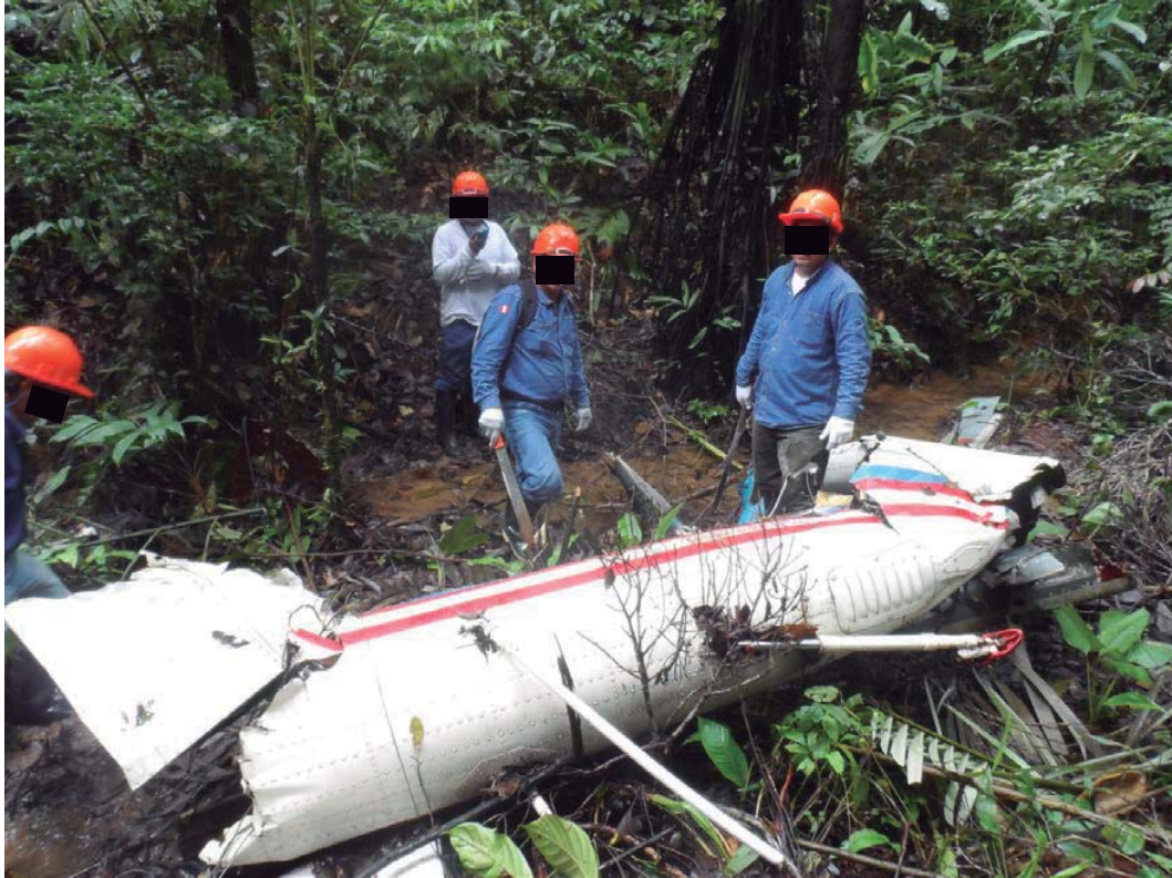
Parte final del botalón de cola, conteniendo el rotor de cola del OB-1916-P, encontrado a 150 metros aproximadamente, del punto de impacto de la cabina.
