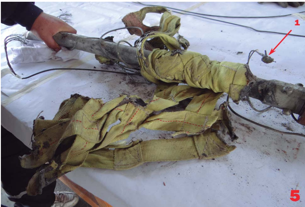
Cable fraccionado y con el extremo cubierto de material sintético de la malla de estiba de carga, derretido por temperatura.
