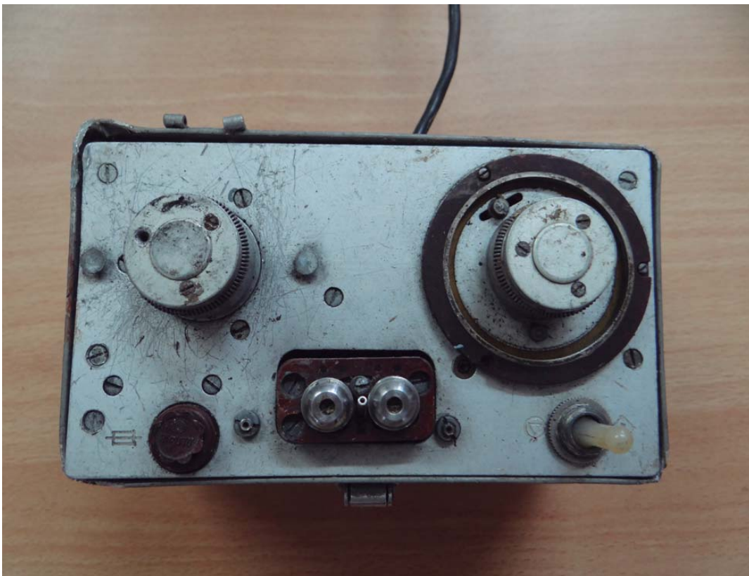
Contenedor del hilo magnético abierto, no se ubicó los carretes del hilo de grabación..
