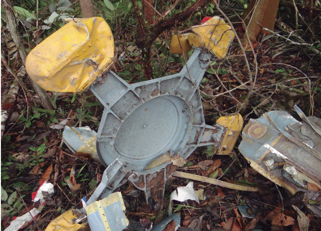
Disco de balance del rotor principal, encontrado a 38 metros del lugar del impacto.
