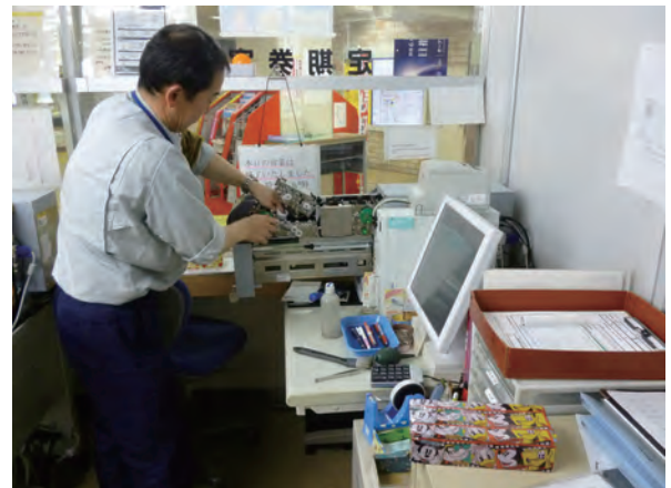
定期券発行機の点検
