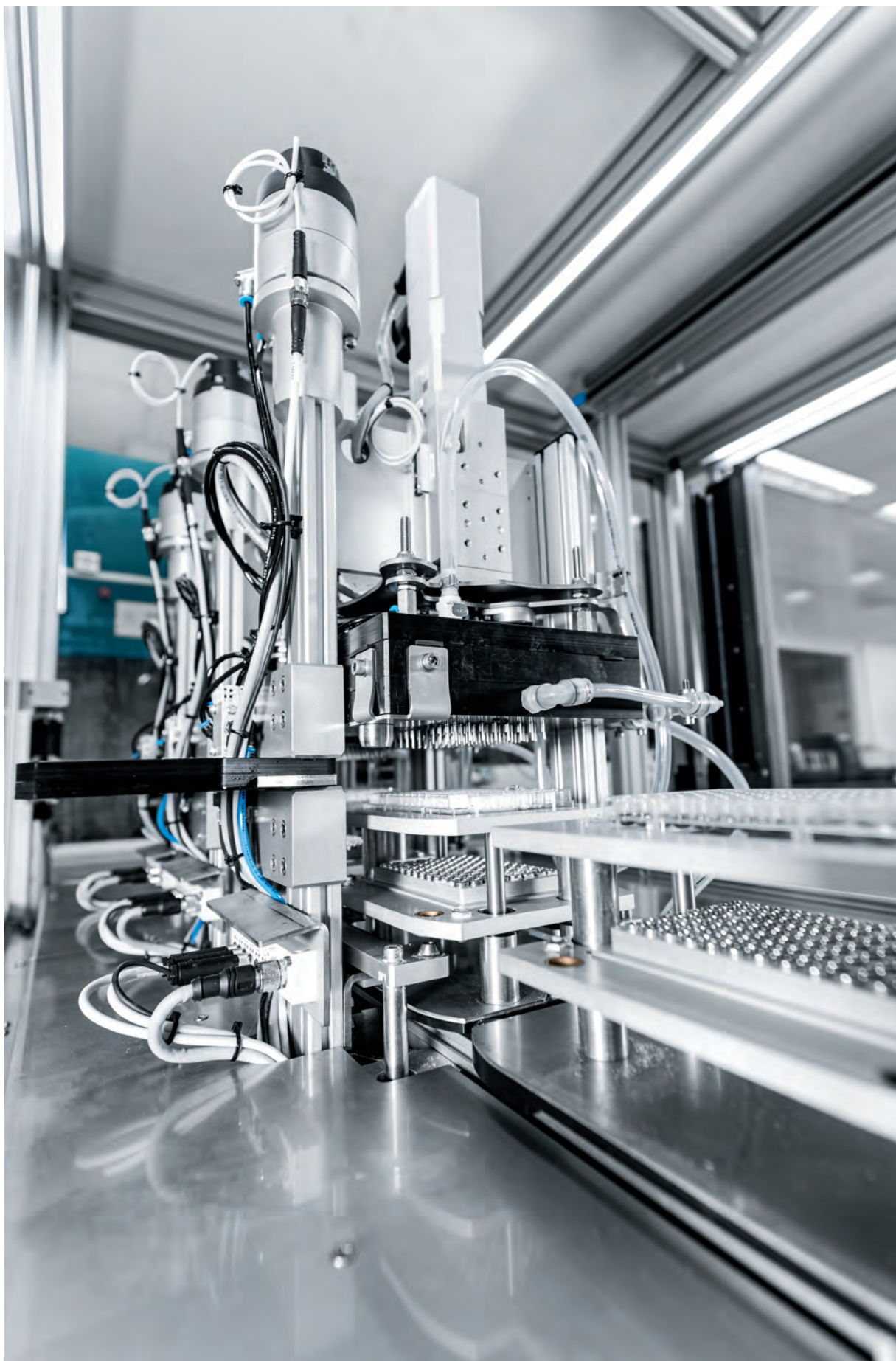
Электрохимический привод EGSC опускает головку с пипетками для добавления жидкости в микропластины на нескольких станциях мойки.
