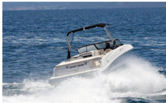
Con la VR6 equipada con un Mercury Mercruiser 4.5 MPI 250 y transmisión Alpha One se pueden alcanzar los 43,4 nudos de punta.
