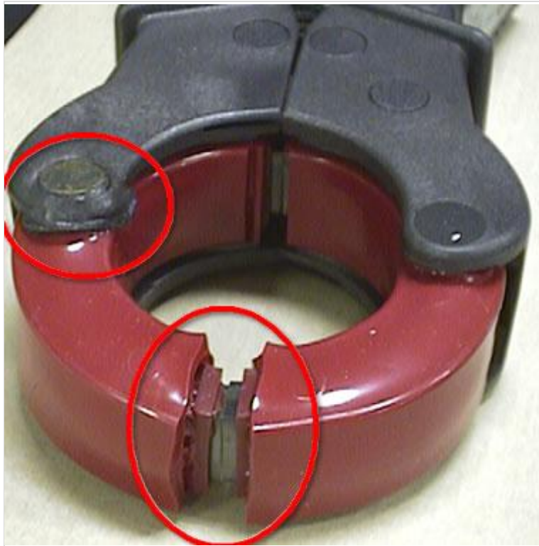
写真 4:プローブの発熱に注意
