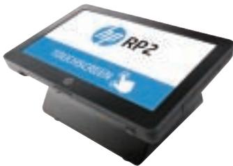
コンパクトで省スペースなタッチスクリーンモニター一体型PC。インテルのクアッドコア・プロセッサを搭載し、14インチワイドのタッチスクリーンは抵抗膜式、静電容量式の2種類から選択可能。ファンレスでIP54レベルの防塵、防滴仕様。水回りか近い飲食店やスペースの限られたカウンター店頭周りでのPOS業務、また台座から外して壁掛型マルチメディアKIOSK、プレイステーションなど幅広い用途で活躍します。
