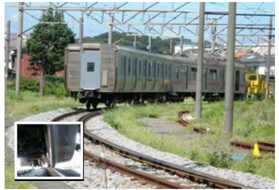
のり上がり脱線走行試験の状況
