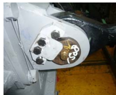
減速機支えピン脱出防止金具
