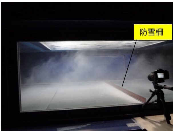
防雪柵効果確認のための降雪風洞実験
