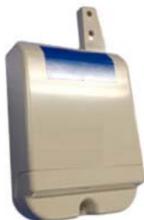
多段中継無線機の外観
