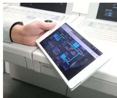
遠方監視システム
