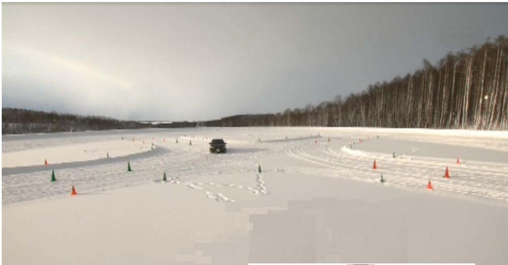
(6) 積雪路面における高速旋回試験
