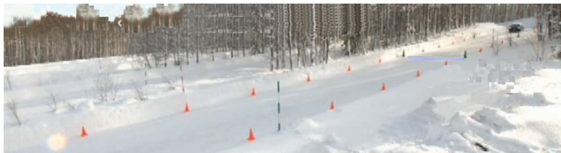
(5) 積雪路面における低速旋回試験
