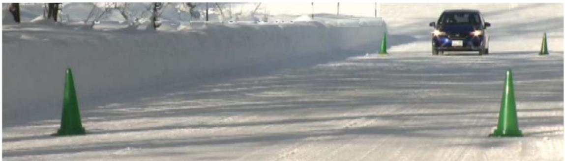
(4) 積雪路面における直線降坂路での制動試験
