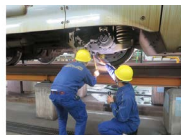
《打音検査の様子》
