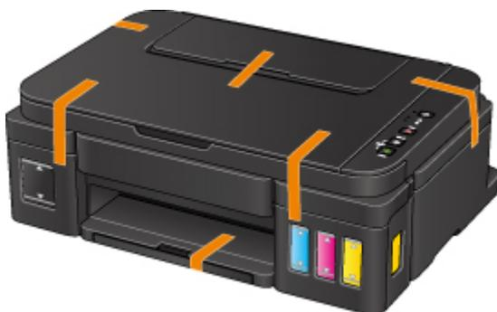
9. Fixez le matériau protecteur à la machine lors de l'emballage de la machine dans le carton.
