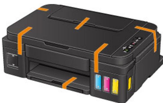
7. Fixez le matériau protecteur à la machine lors de l'emballage de la machine dans le carton.
