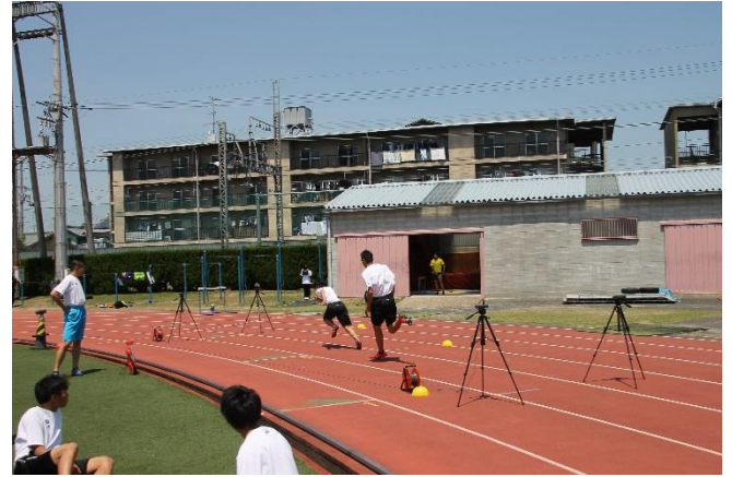
【光電管を用いたタイム計測】
