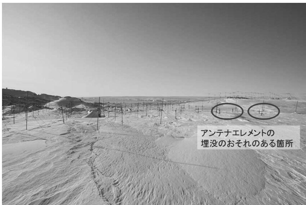
写真Ⅲ3.1.2.1.2-1 リオメータ設置サイトの積雪状況 (重力計室側から PANSY エリア方向に向かって撮影)
