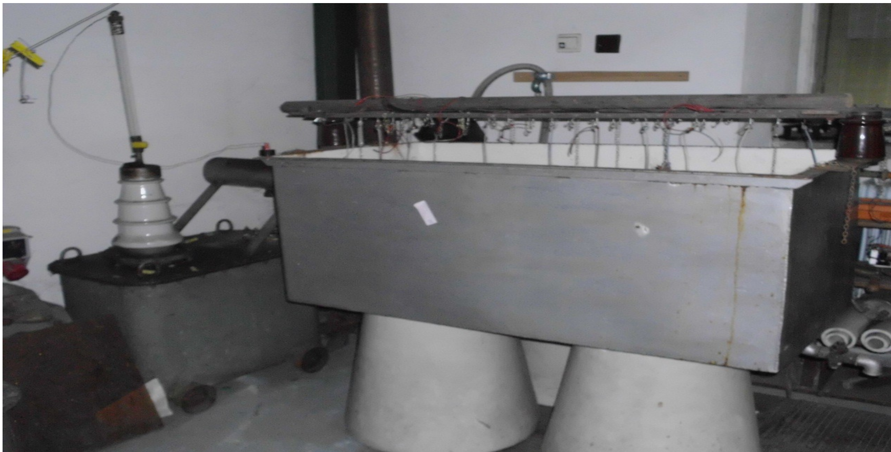
Zdjęcie wanny badawczej i transformatora probierczego
