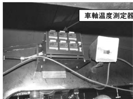
写真-6 車軸温度測定器
