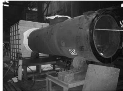
写真-8 ボイラ焼鈍作業
