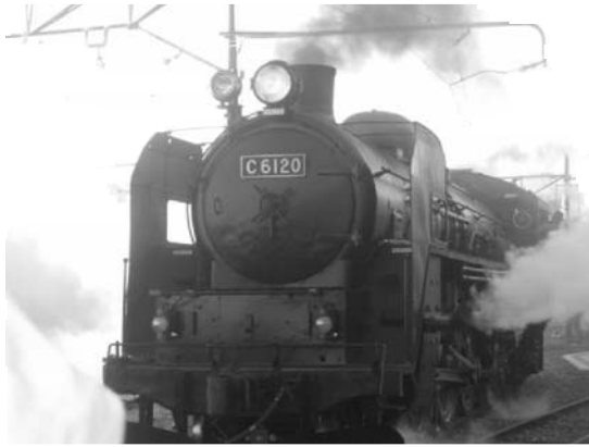
写真一六 吹き試しの光景 (2011.2.18) (シリンダ空気弁座に仮設したノズルから高圧蒸気を噴出させる。このとき、錆や異物も排出する。)
