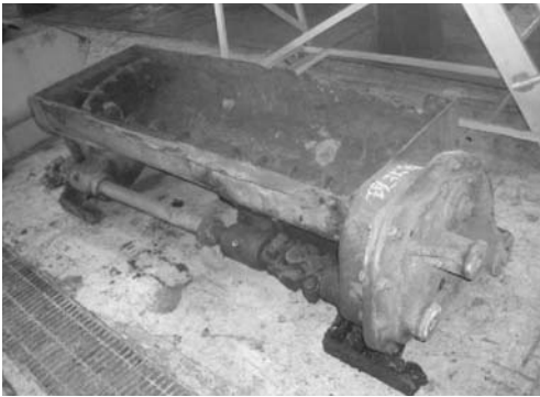
写真-1 外した給炭漏斗を奥側（歯車側）から見る（給炭先の機関車は左側。駆動軸と継手もわかる。）
