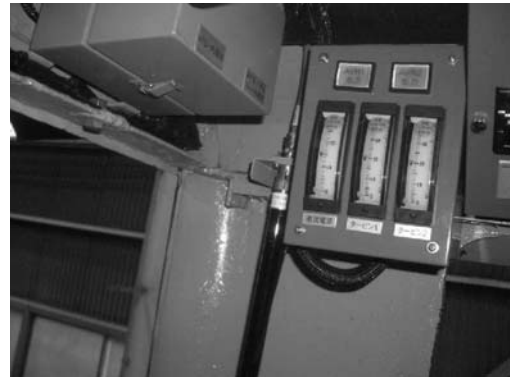
写真-4 助手席右前方に設けた電圧計と動作表示灯（2台のタービン発電機電圧とAVR出力側電圧を表示。）
