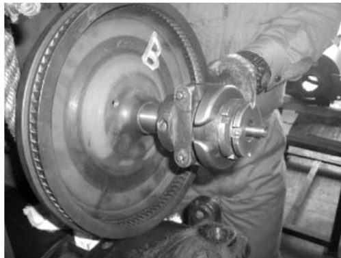
写真-3 1,500 (VA) 発電機用衝動タービンのローター（ローターは800 (VA) 用と共通。今や一般産業界で見ることなく、貴重な存在。中央の部品は調速器。）
