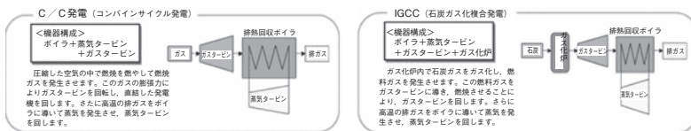
図31 石炭ガス化複合発電IGCC
