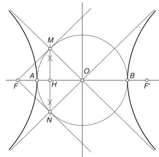
Fig. 6.34. Determinación de las asíntotas de una hipérbola.
