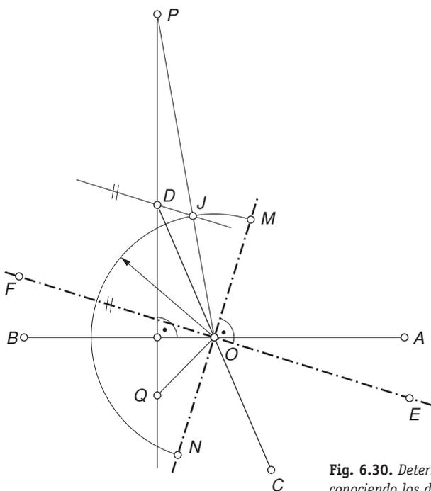
Fig. 6.30. Determinación de los ejes de una elipse conociendo los diámetros conjugados.
