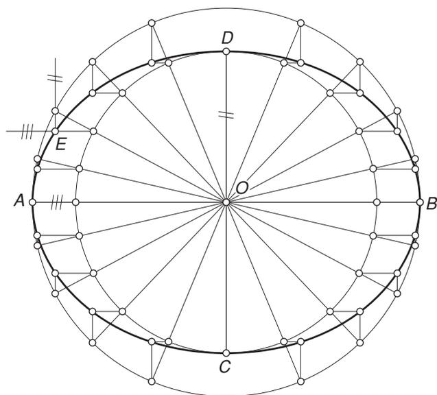
Fig. 6.26. Construcción de la elipse por afinidad.
