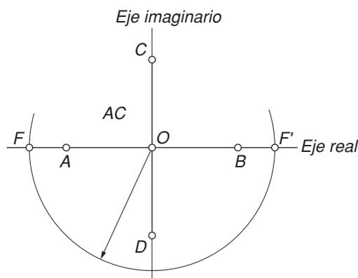
Fig. 6.32. Determinación de los focos de la hipérbola.
