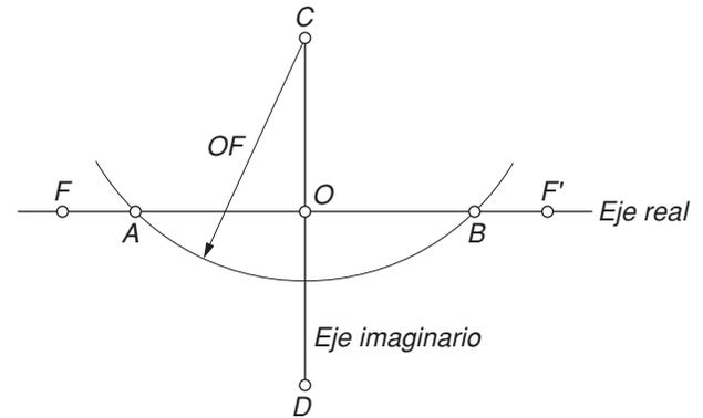
Fig. 6.31. Determinación del eje real de la hipérbola.
