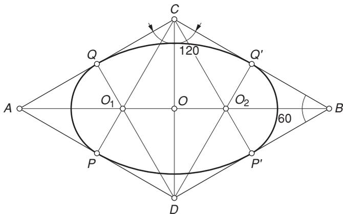
Fig. 6.6. Óvalo isométrico.
