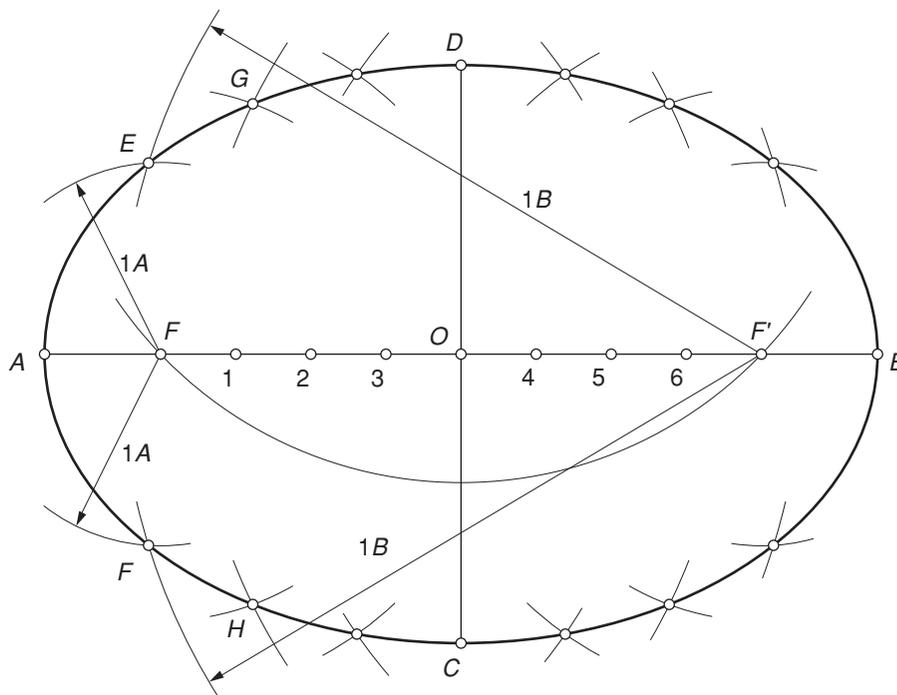
Fig. 6.24. Construcción de la elipse por puntos.
