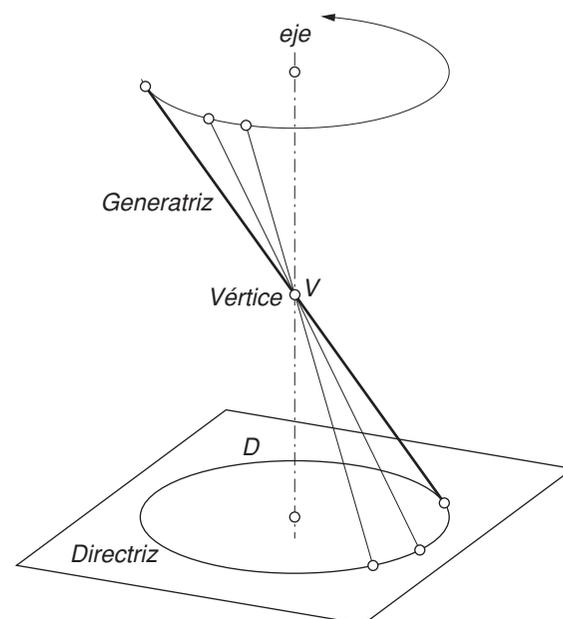
Fig. 6.19. Elementos de un cono de revolución.
