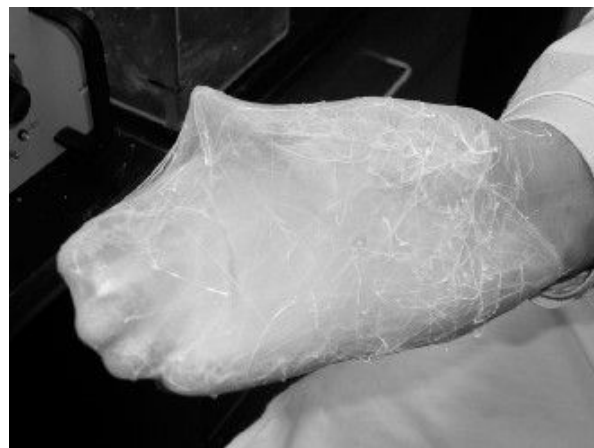
شکل ۵: لایه نانو فیلتر تولیدی توسط روش الکترو اسپینینگ
