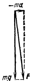
Рис. 315. Сумма F сил mg и -ma отклонена в сторону, обратную ускорению a
