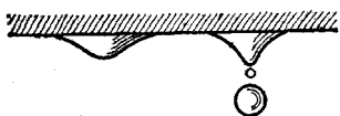
Рис. 372. Повисшая капля воды удерживается от падения силами сцепления. Слишком тяжелая капля падает
