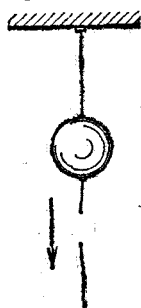
Рис. 88. Резко дернув за нижнюю нить, можно разорвать ее, оставив верхнюю нить целой
