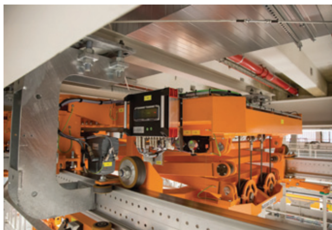
Fot. 3. Kolejka podwieszana z mechatronycznym silnikiem DRC oraz sterownikiem bezpieczeństwa Movisafe HM31B.
