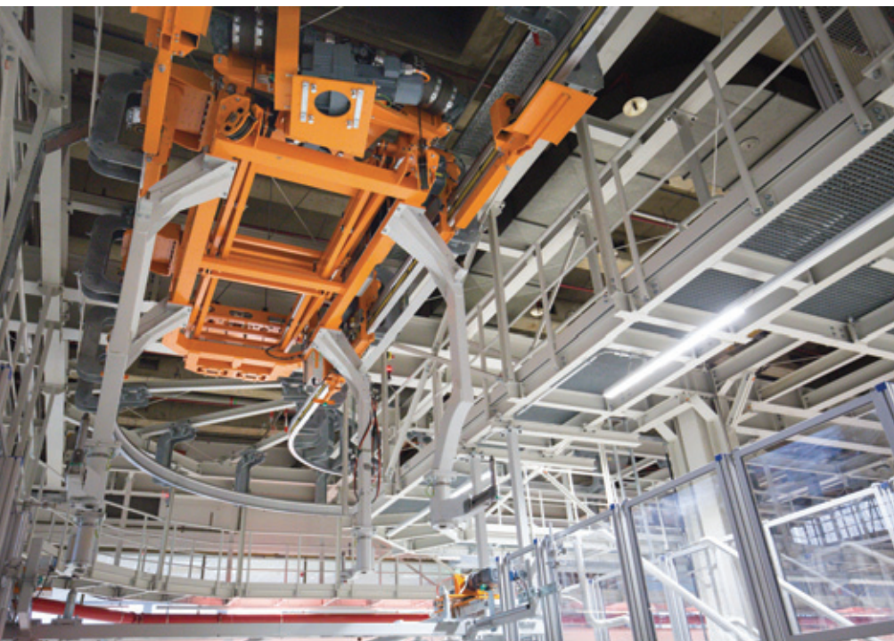
Fot. 1. Unikalne rozwiązanie w branży: dwutorowa kolejka podwieszana (EHB) z redundantnym napędem podnoszenia
