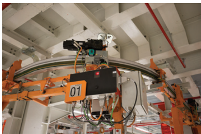
Fot. 4. Sterownik MOVIPRO® i skrzynka rozdzielcza elektrycznej kolejki podwieszanej linii montażu deski rozdzielczej
