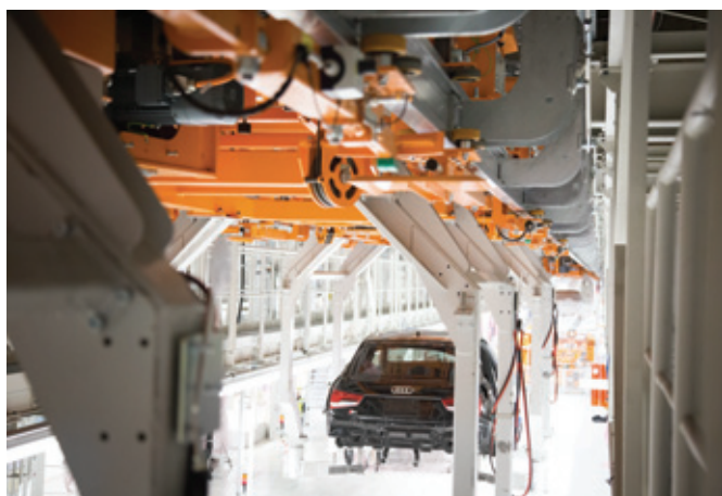
Fot. 2. Produkcja pojazdów o różnych wymiarach w okresie przejściowym – dwutorowa elektryczna kolejka podwieszana z kompaktowym Audi A1 na linii.
