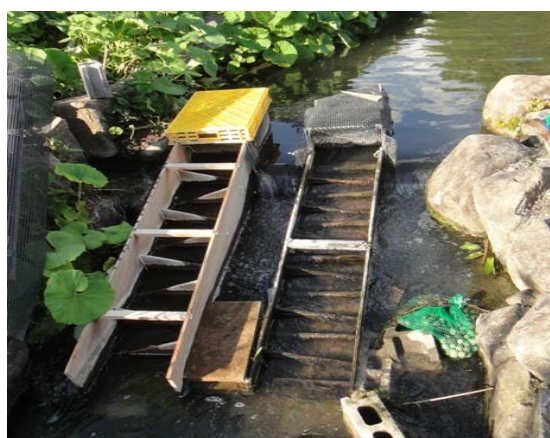
図6 生態試験池における魚道の設置状況 左：千鳥X改良型，右：千鳥X型
