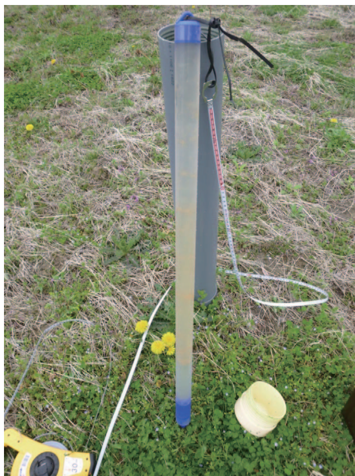
図13 ベーラーサンプラーによる井戸水の採水
