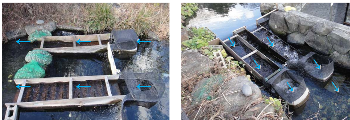
図5 移動生態解明調査における魚道およびトラップの設置状況，左写真：魚道ABと遡上魚用トラップ，右写真：魚道BCと降下魚用トラップ，矢印は水流方向を示す。
