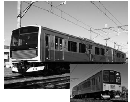
蓄電池駆動電車システムを採用した新型車両 「ACCUM」及び試験車両「NE Trainスマート 電池くん」(右下)
