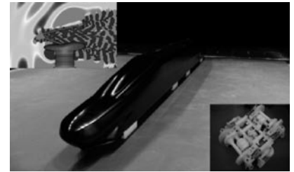
模型を使用した高速走行時における「トンネル 内の車両挙動解析」や「騒音発生メカニズム の解明」
