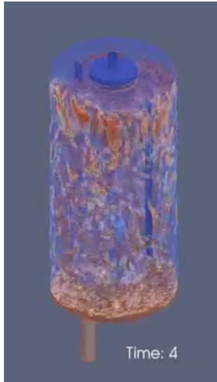
回転攪拌攪拌槽内の流れ mixerVesselAMI
