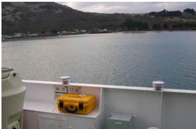
Рис. 7.4. Размещение кейса и двух антенн на крыле мостика
