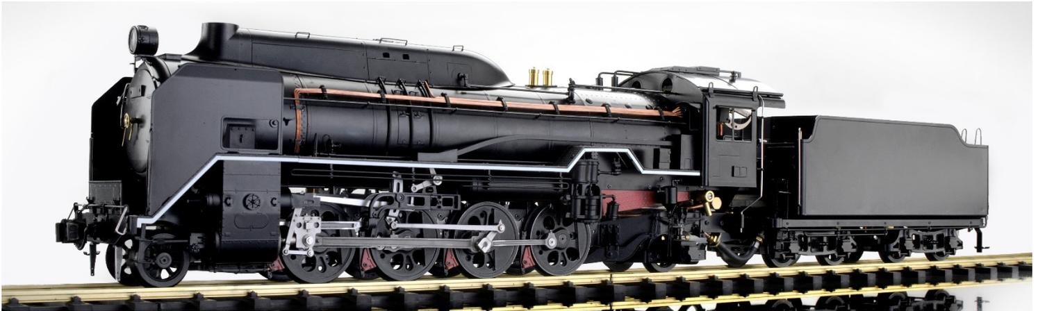
イコライザー・排水弁・鋳鉄車輪で旧型からかなり磨き上げたミカドです
