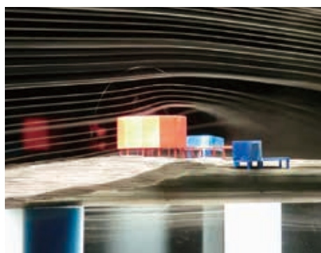
基本観測棟風洞実験(船橋校舎 空気力学研究センター)
