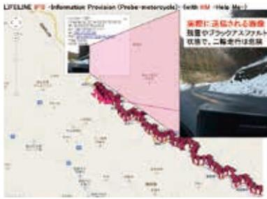
図2 サーバでの災害マップ表示例 (大雪時の道路凍結箇所検出実験)
