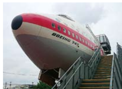
セクション41外観
