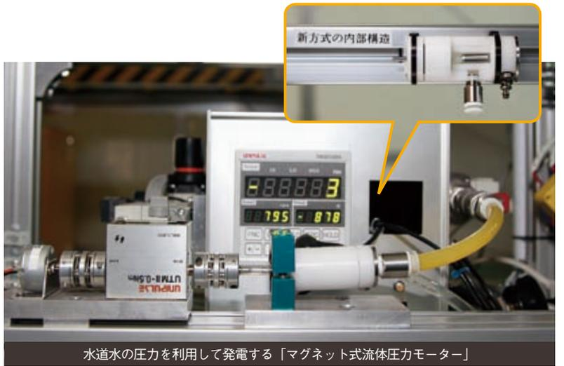
水道水の圧力を利用して発電する「マグネット式流体圧力モーター」
