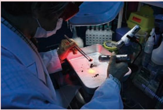
図2 ALS（科学捜査用ライト）を使った燃焼残渣実験の様子
