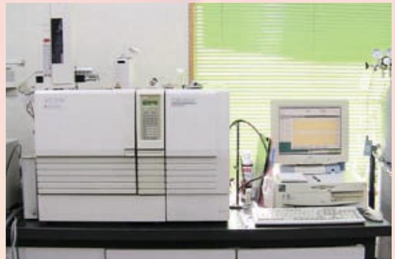
図3 ガスクロマトグラフ質量分析計
