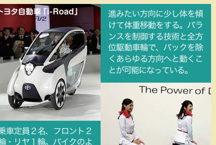
トヨタ自動車「i-Road」 乗車定員2名、フロント2輪・リア1輪。バイクのように車体を傾ける「アクティブリーning」と呼ばれる機構が作動し、安定したコーナリングを可能にしている。
