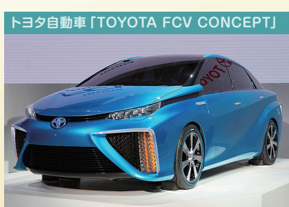
トヨタ自動車「TOYOTA FCV CONCEPT」 ポストハイブリッド車として開発している燃料電池車。固体高分子系燃料電池を使用し、出力密度は世界トップレベルの3.0。実用航続距離は500kmと現行の電気自動車を大きくリードする。
