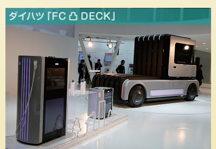
ダイハツ「FC凸DECK」 貴金属フリーの液体燃料電池システムを搭載するゼロエミッション車。手前が燃料電池用の発電機。
