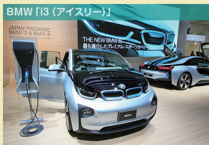
BMW「i3（アイスリー）」 鉄より強く軽いCFRP（炭素繊維強化プラスチック）をボディに全面採用した世界で初めてのモデル。車両重量は1260kgで、電気自動車で先行する日産「リーフ」の1430kgと比べてもかなり軽量。
