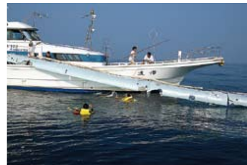
飛行機に並走する船で、着水後バラバラになった機体を回収する。
