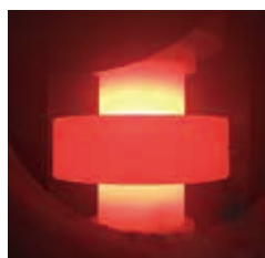
図1 焼結中の放電プラズマ焼結機の炉内
