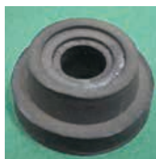
図5 SPSによるニアネットシェイプ成形部品
