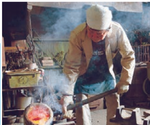
鑄込みの様子
