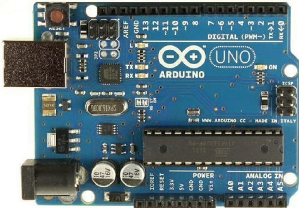
Figure 1.5 : Vue générale de la carte Arduino Uno.
