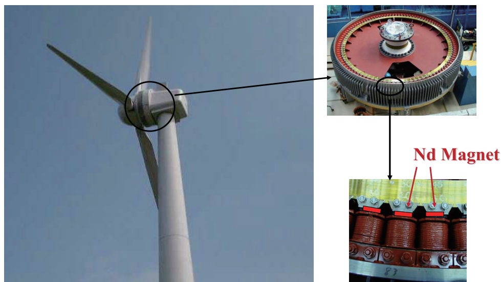
写真3. 風力発電機内のネオジム磁石
