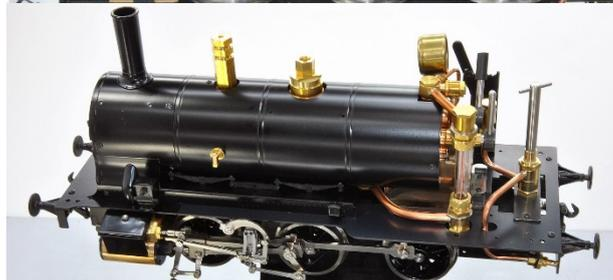
燃料タンクのスペースに組み立てられるバイパス弁の位置と追加される配管を可視化する為に、キャブや付随するディテール部品を外した状態。
