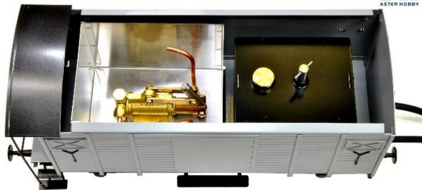
K2 の水槽と、脱着式の燃料タンクの配置。
