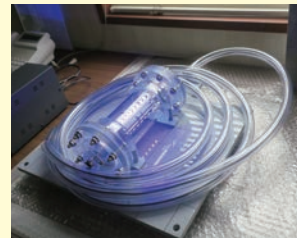
一番効果が高い藍色LEDの光を放つ照射試験装置
