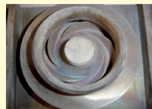
金属粉末レーザー積層RP装置によるポンプインペラー試作品
