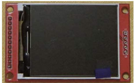
図 1: ILI9225 TFT モジュール 2.2 インチ 176x220 TFT LCD, 4wire SPI
