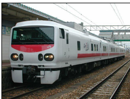
（図③）軌道検測車（East-i）で3カ月に1回線路の歪みを測定
