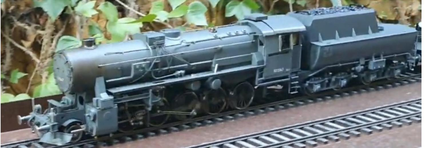
い事態を補う為に、火力(蒸気圧)を上げ、高止まりさせておく手段(バーナーの長さをマニュアルより長めにする)を講じている事が、カラーの高解像度画面から解ります。だからパフォーマンスは絶好調なんです。これも或る種、調整方法なのですが、この調整方法の場合、煙室部分が過度に熱くなる傾向が有り、煙室内の溶接部品が壊れる危険性が有ります。上級者が陥りがちのつまづき躓きなのですが、淡い色で塗装された煙室(グレーや銀色)はたちまち茶色や黒く変色し最悪塗装は「剥離」します。その段階で Oリングやバスコーク等がダメになっていて、溶接部分が逝かれる場合もございます。特に上級者の方！” 御注意下さい
